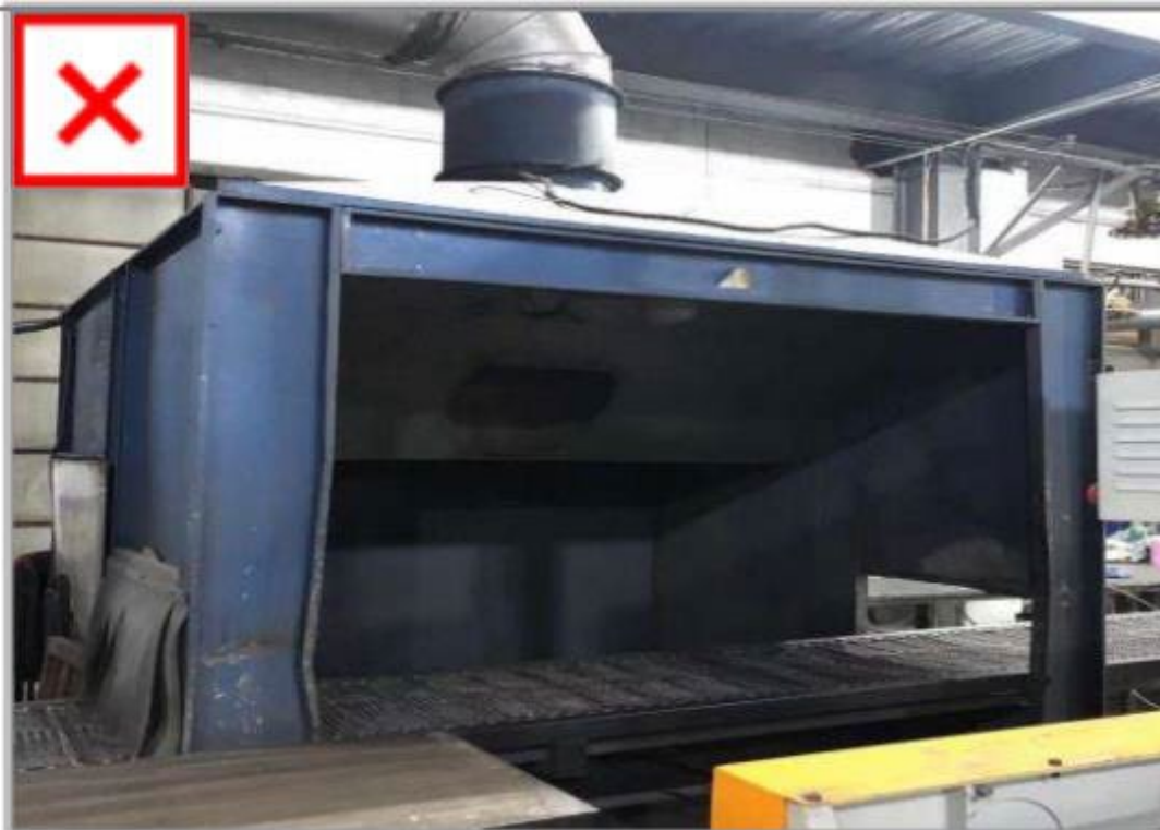
铝镁抛光不应采用正压输送
