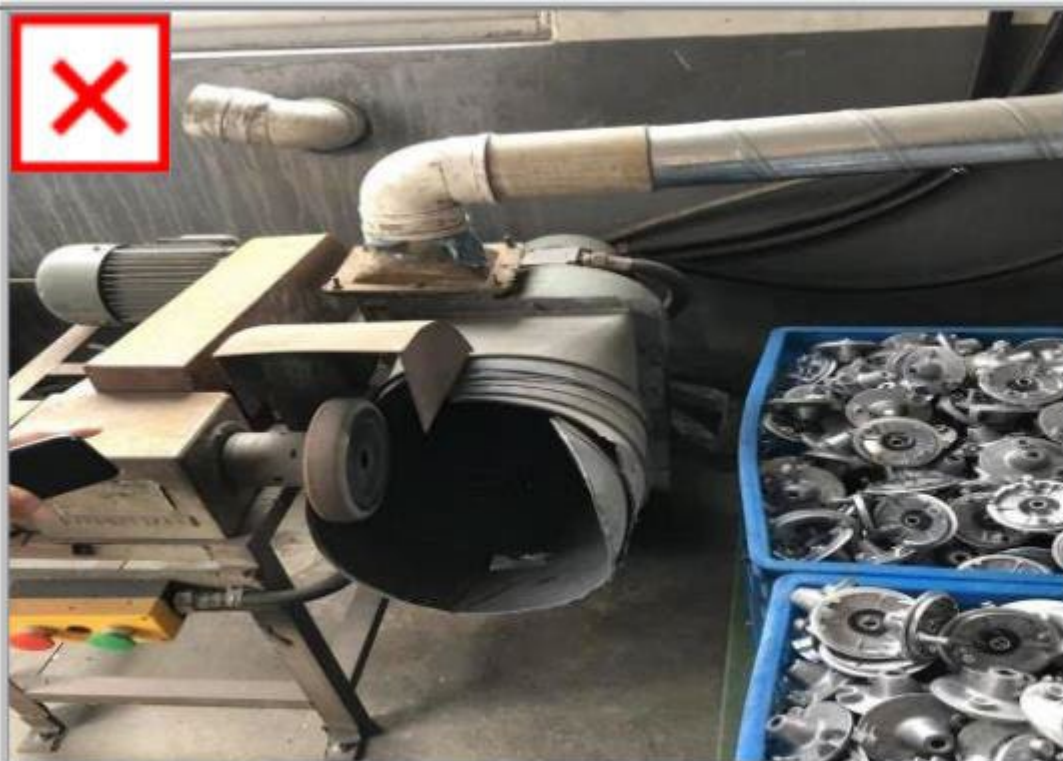
铝镁抛光不应采用正压输送
