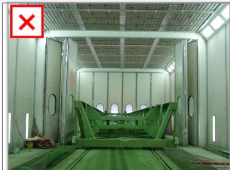
未设置固定式可燃气体浓度监测报警装置
