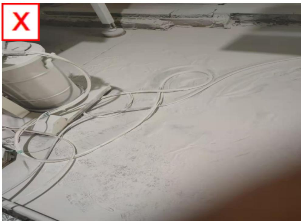
隐患描述:除尘系统风量不足, 粉尘外溢, 喷粉房粉筒周边积尘严重。
