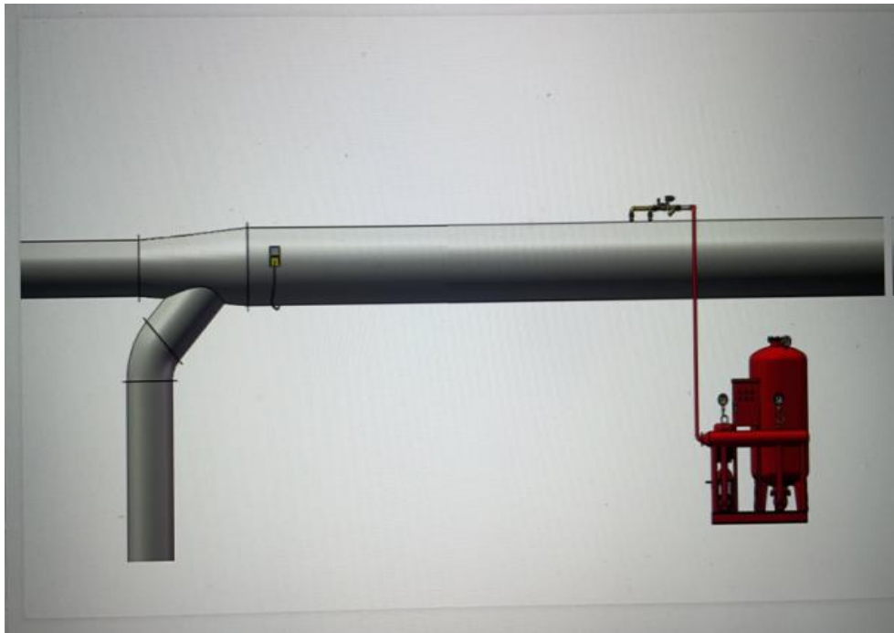
情景描述：火花探测熄灭装置示意图。
