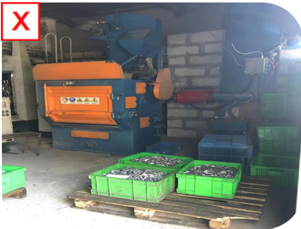
隐患描述：铝镁抛丸除尘器安装在抛丸机旁已做隔离，但防护隔离不全，隔爆阀未隔离在工作岗位以外。
