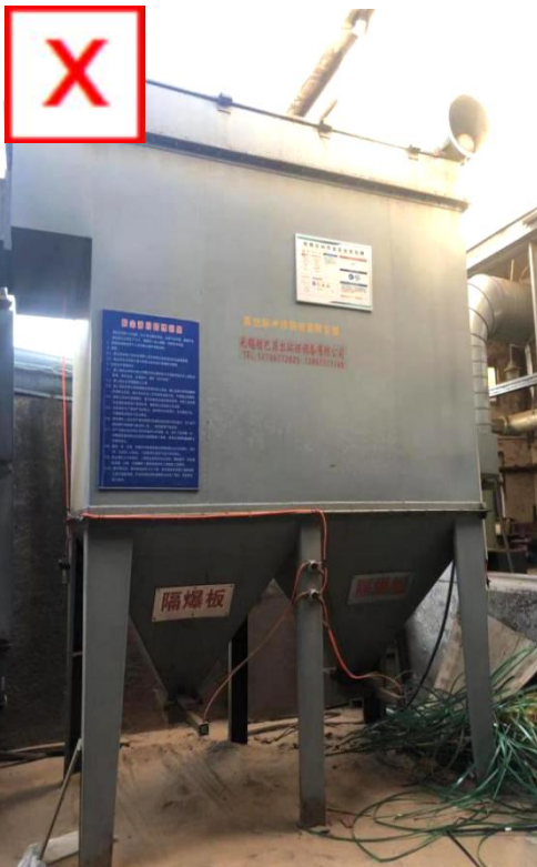
重大隐患描述：木粉尘除尘系统无任何控爆措施。
